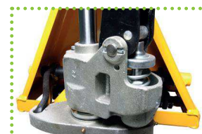
Pompa monoblocco zincata con protezione molla, serbatoio interno e ingrassatori
