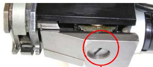
REGOLAZIONE DISTANZA TRA RULLO DI TRASCINAMENTO E PIASTRINA DI CONTRASTO
