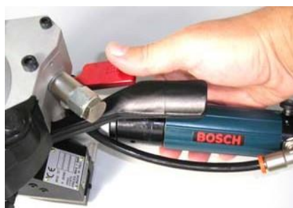
FASE 2; AZIONAMENTO LEVA SIGILLATURA E TAGLIO REGGIA
