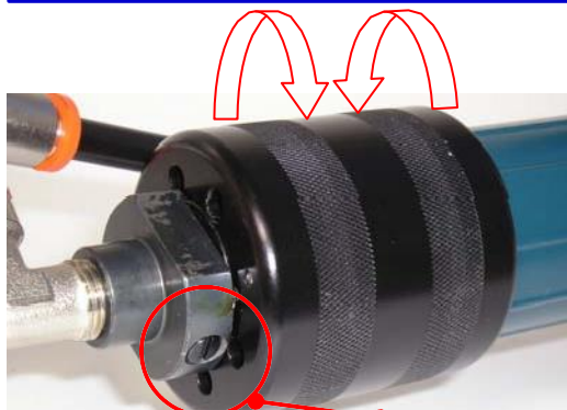
AGIRE SU QUESTA VITE PER REGOLARE LA FORZA DI TENSIONE DEL MOTORE
