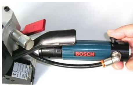
FASE 1 : AZIONAMENTO TENSIONE REGGIA
